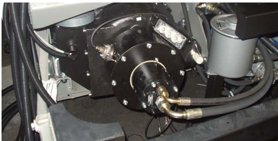
Двигатель 20ML 3550 K/4 во время установки в троллейбус SKODA 24Tr IRISBUS. Направляющая кабеля с ответной частью с аксиальными гнездами модульного соединителя HC на 350А, подключаемыми на конце
